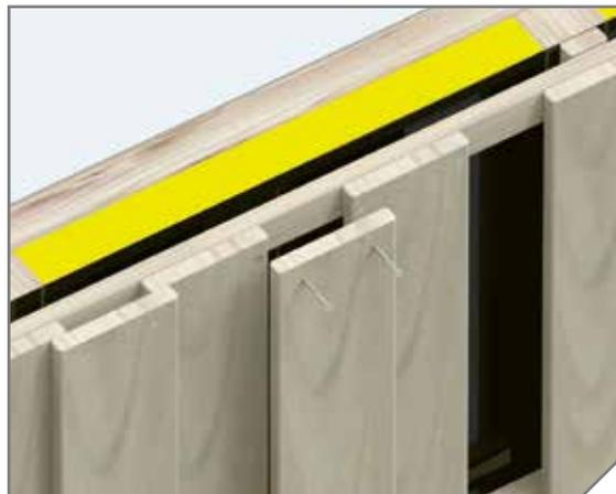
Das Boden- und das Deckelbrett muss bis zu einer Brettbreite von < 80 mm mit mind. 1 Schraube verschraubt werden und bei Breiten > 80 mm mit mindestens 2 Schrauben. Die Verschraubung des Bodenbrettes kann in dem Bereich der 20 mm Überlappung unsichtbar ausgeführt werden. Der Abstand der Schraube zur Außenkante muss jedoch > 15 mm sein.
