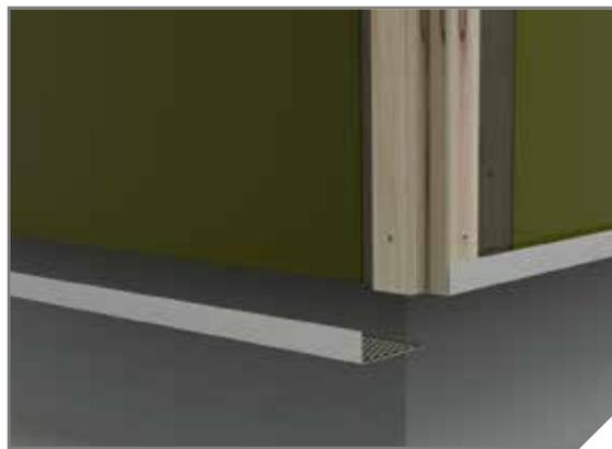
Die Schutzgitter müssen im unteren Belüftungsbereich und an der oberen Kante angebracht werden. Dies gilt auch im Fensterbereich.
