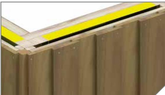
Bei einer Boden-Deckel-Schalung und bei einer Boden-Leisten-Schalung kann mit einem Rahmenholz eine optimale Eckausbildung hergestellt werden. Bei der Einteilung sollte darauf geachtet werden, dass die Bekleidung der Fassade immer mit dem Bodenbrett beginnt bzw. endet.
