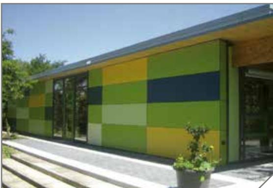
Für die Verwendung von HPL-Platten für vorgehängte hinterlüftete Fassaden sind Produkte mit einem ausreichenden Langzeitwitterungsschutz zu verwenden.
