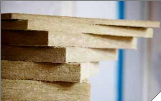
Dämmstoffe müssen den Wärmeschutzanforderungen der DIN 4108 „Wärmeschutz im Hochbau“ und den Anforderungen an den Wärmeschutz zur Energieeinsparung entsprechen. Durch diese Anforderungen und Vorgaben soll ganzjährig ein möglichst gleichbleibendes Innenraumklima erreicht werden. Weiterhin sollen sie zu einer Reduzierung von Heizenergie und umweltschädigenden Abgasen führen. Wärmeverluste in den kalten Wintermonaten können bei richtiger Anwendung vermieden werden.
