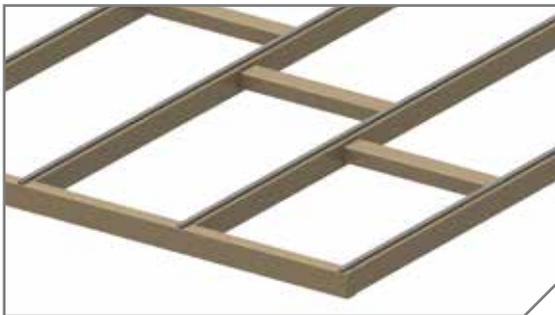
*Legen Sie die Querstücke waagrecht zwischen die senkrecht verlegte Unterkonstruktion und montieren Sie die Wechsel mittig. So ist eine ausreichende Belüftung und Entwässerung sichergestellt.*
