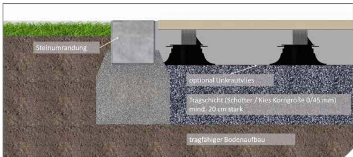
Bei beiden Varianten müssen die Achsabstände der Betonplatten oder der Verstellfüße auf die geplanten Abmessungen und Materialien für die Unterkonstruktion und Terrassendielen abgestimmt werden. Da bei der Verwendung von Verstellfüßen keine Befestigung der Unterkonstruktion am Untergrund möglich ist, sollte ein ausgesteifte Rahmenkonstruktion erstellt werden. Bitte beachten Sie vorrangig die Herstellerinformationen zu den Verstellfüßen.
