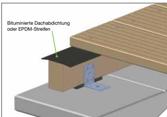
Durch den Einbau von Abstandhaltern oder EPDM-Streifen kann Holz ausreichend schnell abtrocknen.
