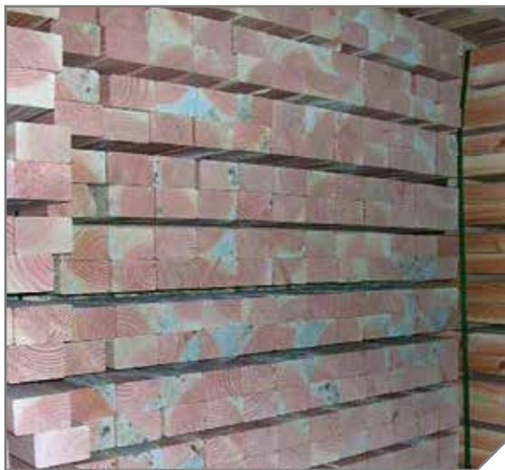
werden blaue bis grau-schwarze Verfärbungen hervorgerufen. Durch Holz Trocknung kann einer Verblauung vorgebeugt werden. Die Holzfeuchte sollte unter 20% liegen. Auch Schimmelpilze können zu Verfärbungen führen, sind aber nach Abtrocknung einfach durch Abfegen zu beseitigen. Diese Verfärbungen sind bei Terrassendielen kein Reklamationsgrund.
