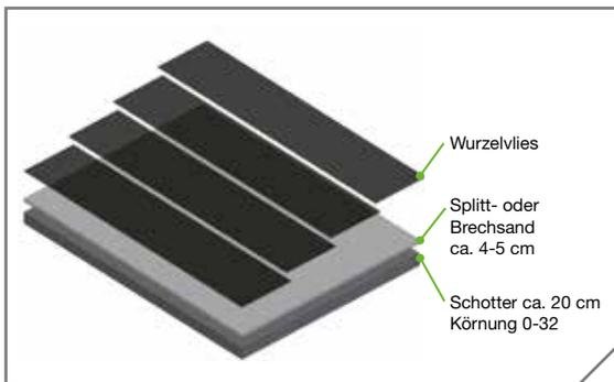
Ein optimaler Aufbau sollte wasserdurchlässig und ausreichend verdichtet sein.
