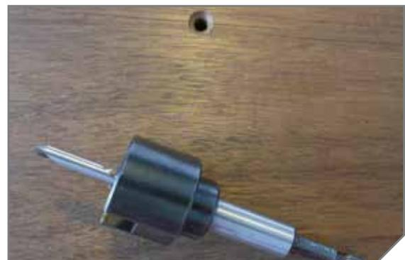
*Spezialbohrer mit eingebautem Versenker ermöglichen eine saubere und gleichmäßige Verschraubung.*
