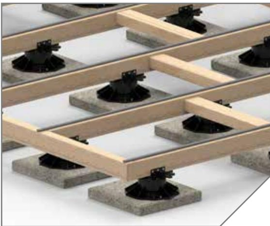
*Zur Absicherung der Windlasten müssen z.B. bei Dachterrassen die Verstellfüße an der Unterkonstruktion sowie auf den Betonplatten befestigt werden.*
