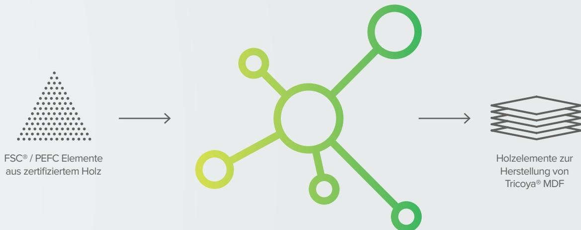
Es handelt sich um ein revolutionäres nachhaltiges Verfahren, das seit 2007 an Massivholz kommerziell verwendet wird, bei dem die Hydroxylgruppen (chemische Formel: -OH) gegen Acetylgruppen ausgetauscht werden (chemische Formel: -COCH<sub>3</sub>), was eine Wasseraufnahme reduziert und so die Dimensionsstabilität und Dauerhaftigkeit des Holzes verbessert.
