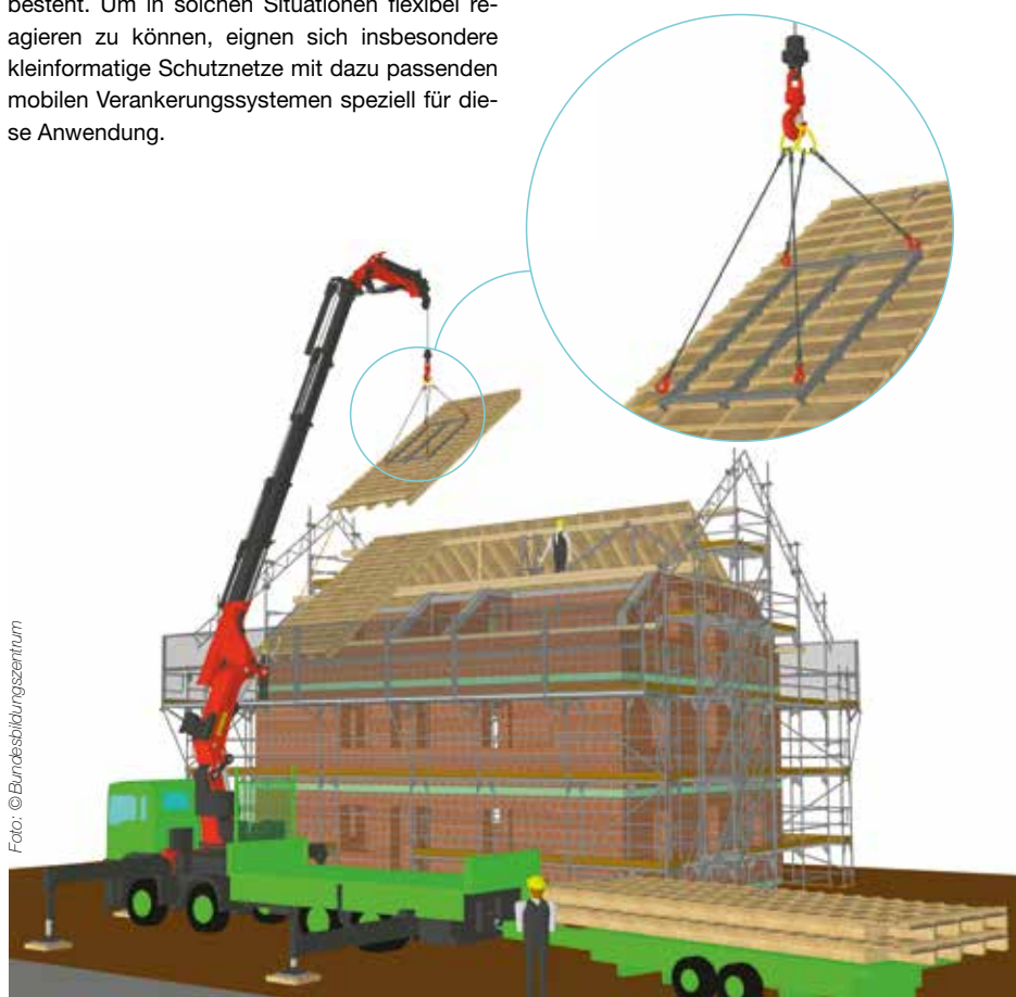
Abb.3: Durch das Richten von Dachelementen können Aufenthalte an Absturzkanten minimiert werden. Die Absturzgefahr nach innen ist durch die flächigen Elemente deutlich reduziert gegenüber dem konventionellen Richten.
