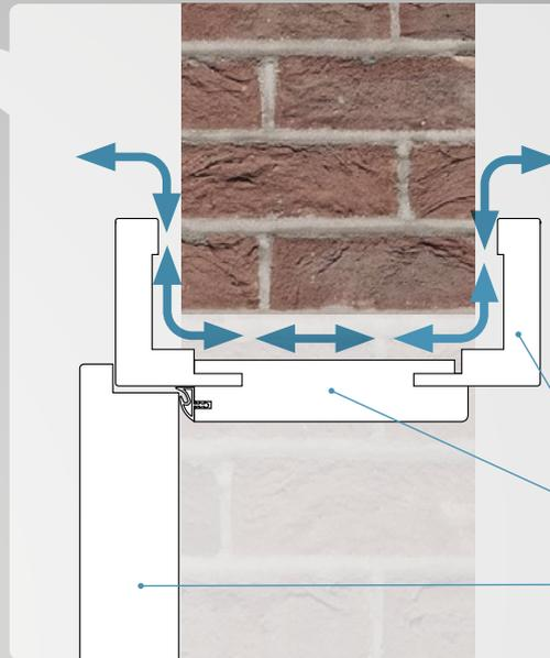
Im oberen Bekleidungsbereich der Zarge wird eine Luftströmungspassage geschaffen, die einen Luftaustausch von Raum zu Raum ermöglicht. Optisch ist das der Zarge nicht anzusehen und ohne große Mehrkosten erhältlich.
