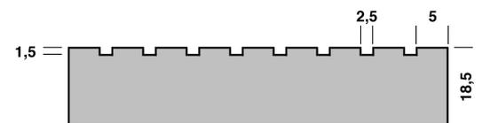
**Match** ist eine geradlinig verlaufende Struktur in Form eines Stabprofils, mit Verprägungen in einem Abstand von 2,5 mm und einer Breite von 5,0 mm. Die Tiefe der Verprägung beträgt 1,5 mm.
