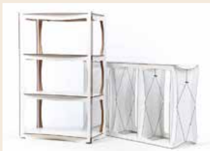
Leichtbau-Regal LB2 von Thomas Beck aus Berlin aus 5 mm dünnem HDF, melaminbeschichtet, mit nur 8,4 kg Gewicht bei einer Größe von H 1250 x B 780 x T 400 mm. Bei Belastung der Fachböden möchte sich die Unterkante der vorgespannten Zargen nach außen verdrehen, aber das dünne Zugseil wirkt dieser Torsion entgegen.
