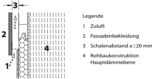
Abb. 54: Die Bekleidung wird auf einer Traglattung befestigt. Die Ebene der Traglattung bildet die notwendige Luftschicht.
