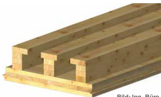
Abb. 17 Deckenelement aus Brettsperrholz in einer aufgelösten Variante. Auf der Unterseite befinden sich im Elementaufbau die Sperrlagen, die Rippen verlaufen in Tragrichtung. Dieser Aufbau trägt zur Holzeinsparung bei und hat Vorteile bei der Installation und einer Deckenbeschwerung in den Hohlräumen.
