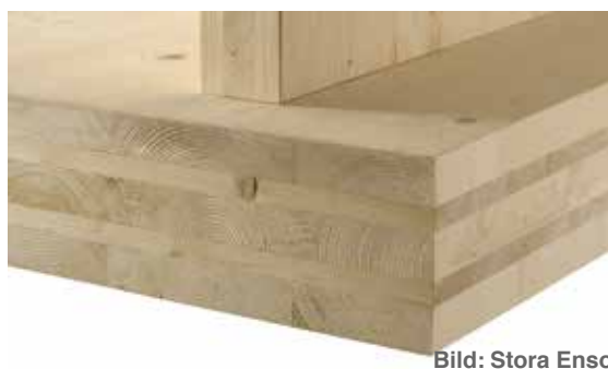
Abb. 14 Brettsperrholz folgt dem Prinzip des Sperrholzes. Die quer zueinander verlaufenden Brettlagen „sperrn“ die holztypische Schwind- und Quellverformung auf 1/25.
