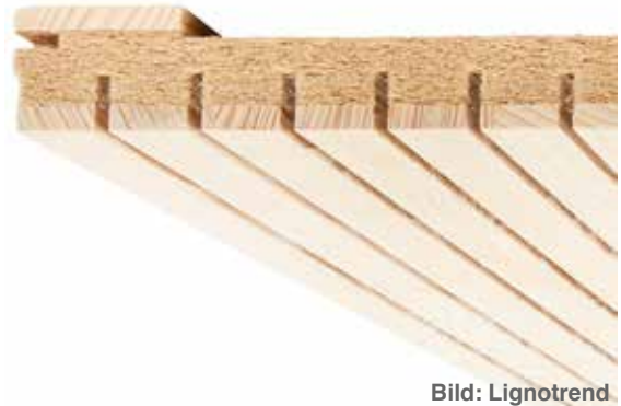
Abb. 22 Die raumseitige Brettlage wird mit Sägeschnitten genutet. Zwischen der dahinterliegenden Sparlattung ist Holzfaserdämmung zur Schallabsorption eingelegt. Dargestellt sind Bekleidungs-elemente zur nachträglichen Montage.
