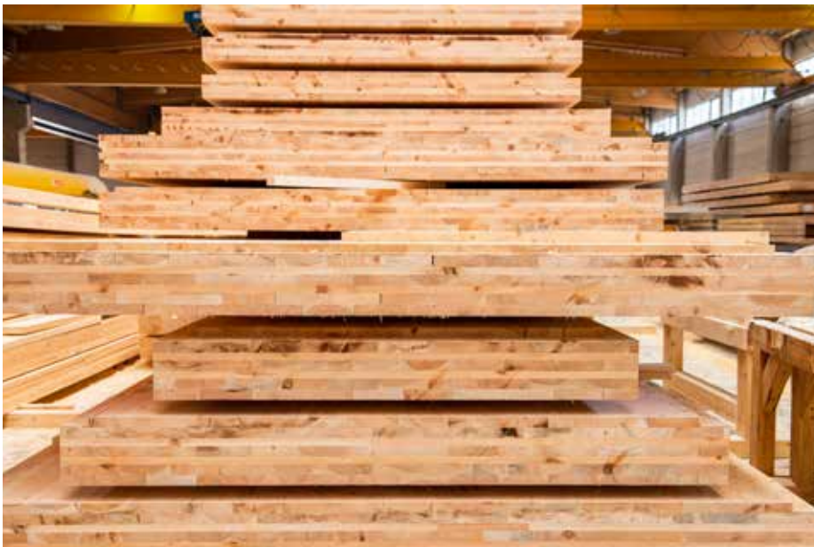
Brettsperrholz (CLT) vorgefertigt, Foto Ziegler Group
