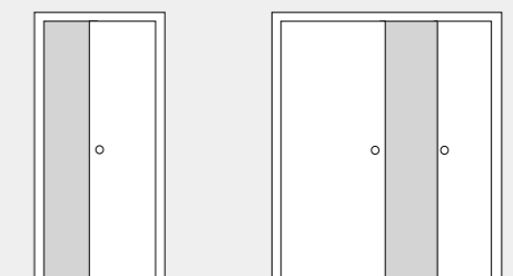
Schiebetür in Wand
